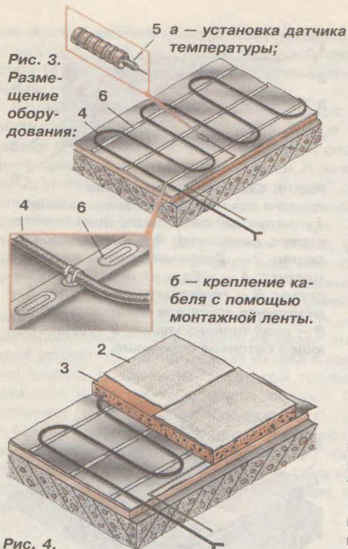
Рис. 4. Заливка кабелей бетонным раствором.
